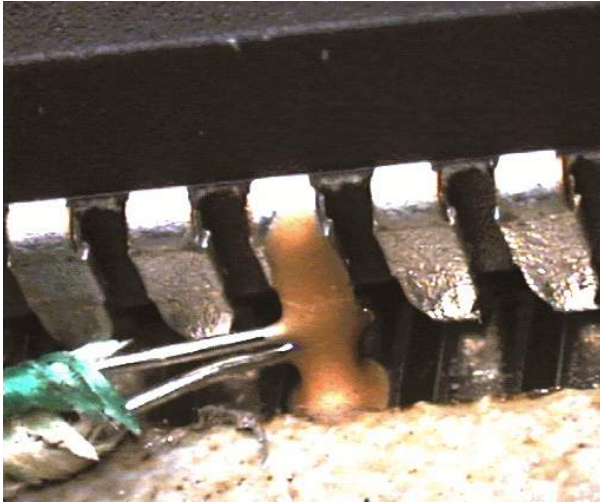
Bild 7: Fixierung eines ungemantelten Thermoelements mittels SMD-Klebstoffs
